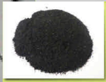
Il recupero dei pneumatici usati avviene, con la triturazione: alla temperatura di 100° sotto zero raggiunta tramite l'impiego di azoto liquido.
